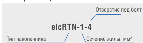
Схема артикулов наконечников кольцевых из листовой меди неизолированных, тип ПМ
