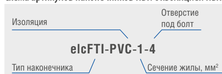
Схема артикулов наконечников НВИ с изоляцией ПВХ
