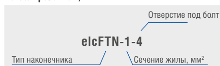
Схема артикулов наконечников вилочных из листовой меди неизолированных, тип ПМ
